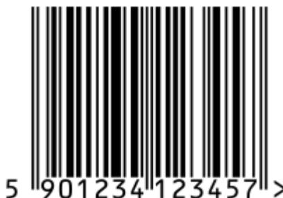
*Figura 2.1: Esempio di codice a barre lineare: EAN-13*
